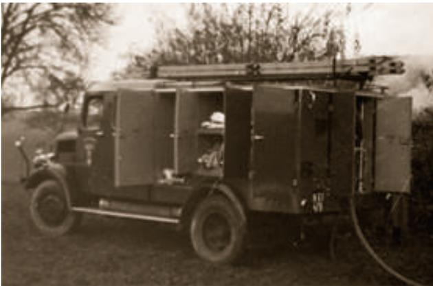
1955 Aufbau des Opeltankers auf Opel Blitz
